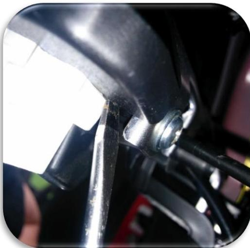
OBD-Buchse aus Halterung entfernen
