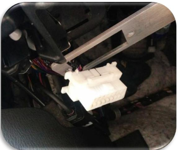
OBD-Buchse durch die Öffnung des Halbleches stecken
