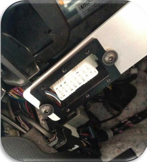
Gehäuse inkl. OBD-Buchse mit Halterahmen
