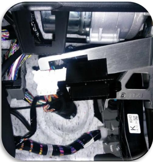
Gehäuse und OBD-Buchse zusammenführen
