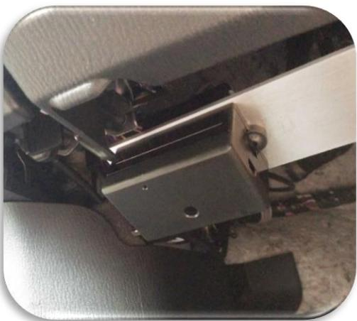
OBD-Saver schließen und Schlüssel entfernen
