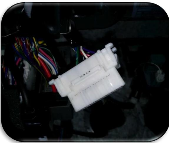
Kunststoffsteg an OBD-Buchse entfernen
